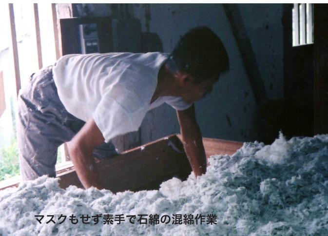
マスクもせず素手で石綿の混綿作業
